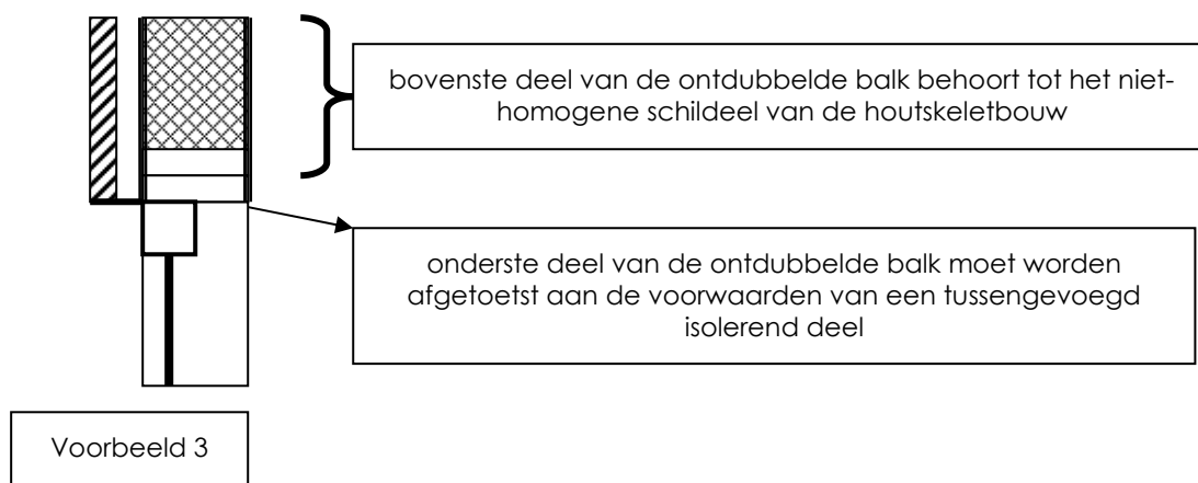
Figuur 9.3 - ontdubbelde balk boven vensters bij houtskeletbouw
