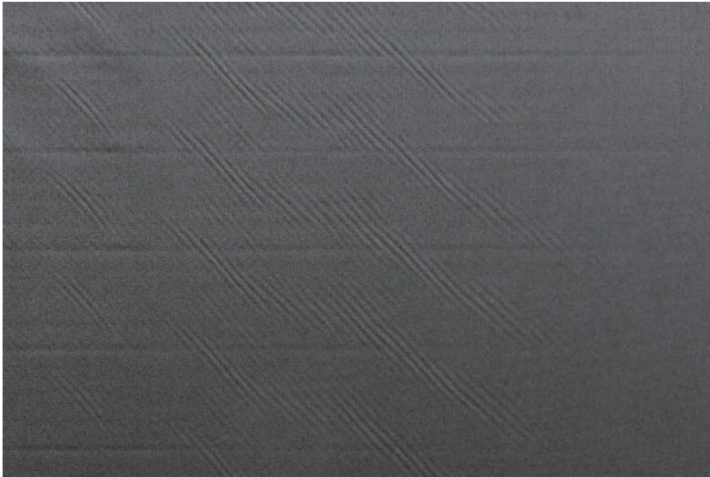
Illustration 9.4.4 - Empreintes transversales dues au raccordement au tube d'enroulement faisant apparaître des coutures transversales dans la toile, voir 4.2.7
