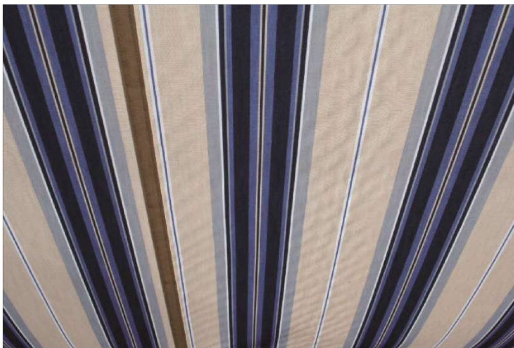
Illustration 9.1.10 - Ondulation admissible dans le lé (gaufrage)
