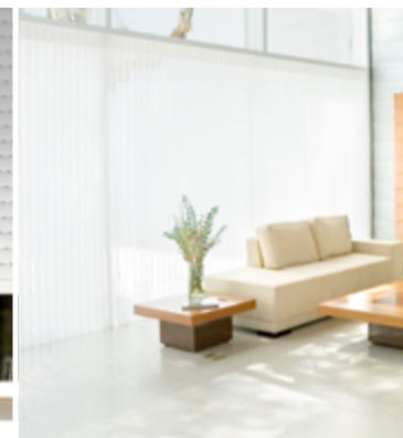
Binnenjaloezie minder efficiënt dan buitenzonwering, maar beschermt tegen verblinding
