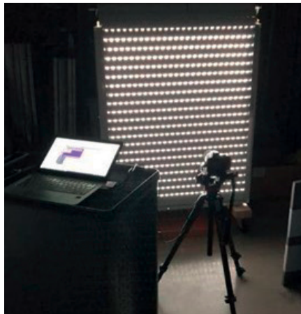
Afbeeldingen 19 en 20: Meetopstelling: Een rolluikblad wordt van buitenaf gelijkmatig verlicht met een gespecificeerde lichtinstallatie met gedefinieerde luminantie en lichtdichtheid. Aan de binnenkant wordt de luminantie of lichtsterkte gemeten met een fotometrische camera en op de computer geanalyseerd. (Bron: Hella)
